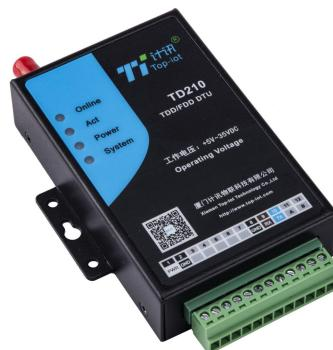
TD210系列DTU是一款工业级无线数传终端，设计完全满足工业级标准和工业用户的需求，采用高性能的工业级32位通信处理器，软件多级检测和硬件多重保护机制来提高设备稳定性。支持各运营商4G网络，接口使用灵活，支持标准RS232、RS485接口，可定制TTL电平。
